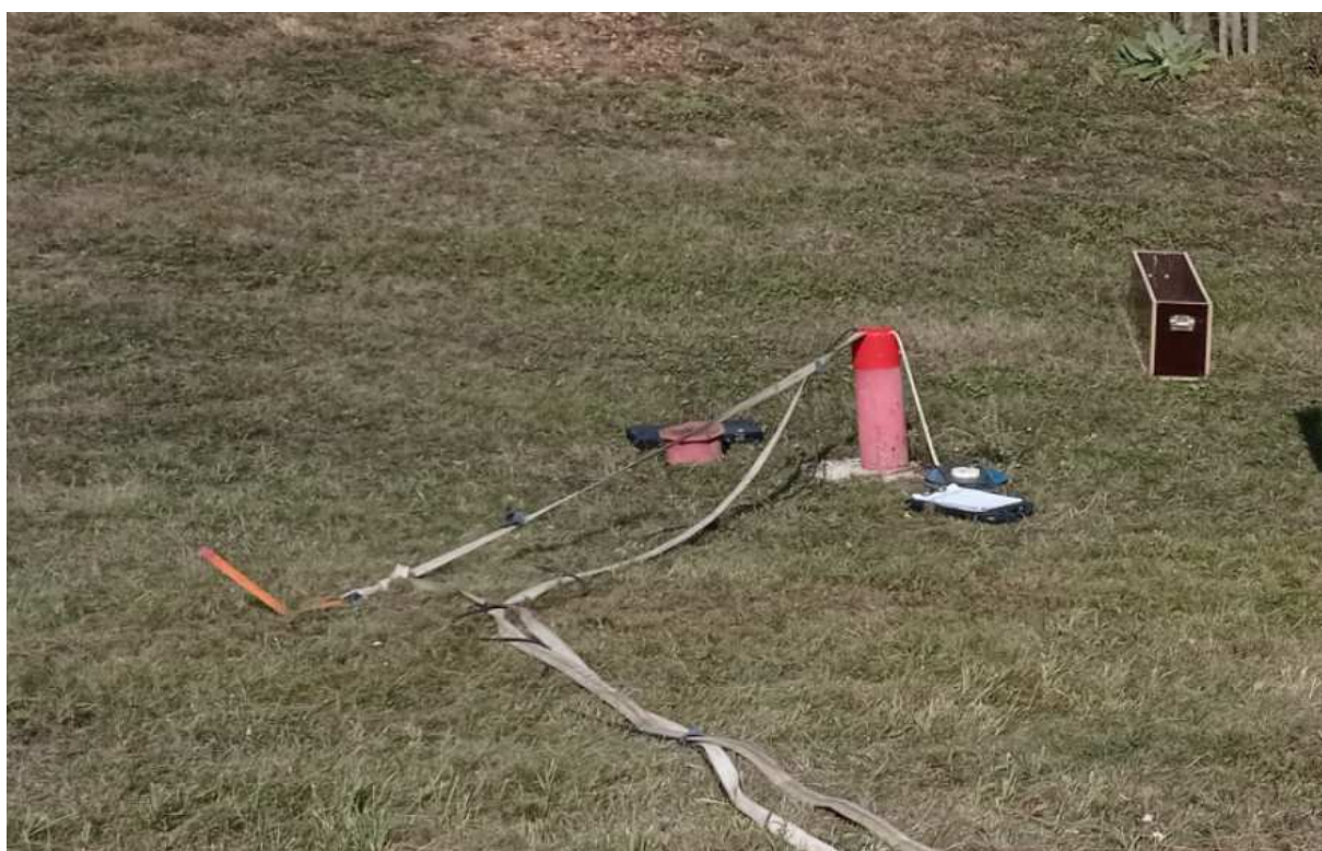
Foto 4: Realizace čerpací zkoušky ve vrtu HV 8
