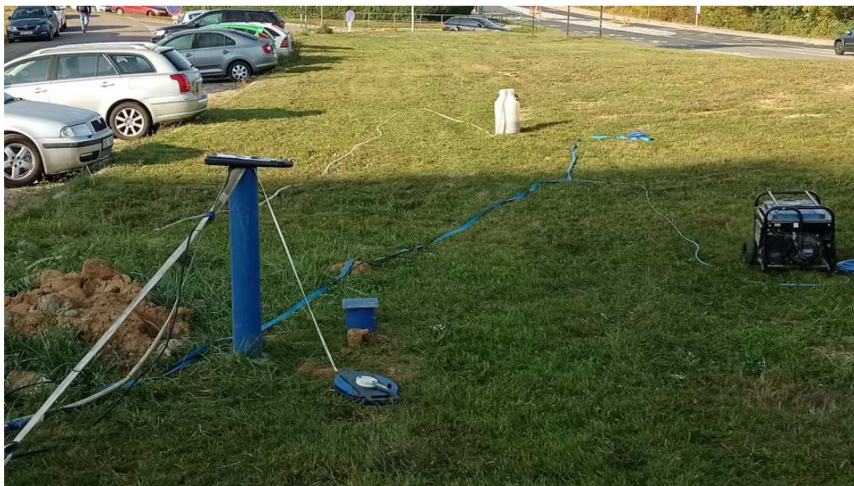
Foto 1: Realizace čerpací zkoušky ve vrtu HV 110
