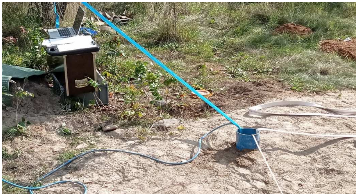
Foto 3: Realizace čerpací zkoušky ve vrtu HV 121
