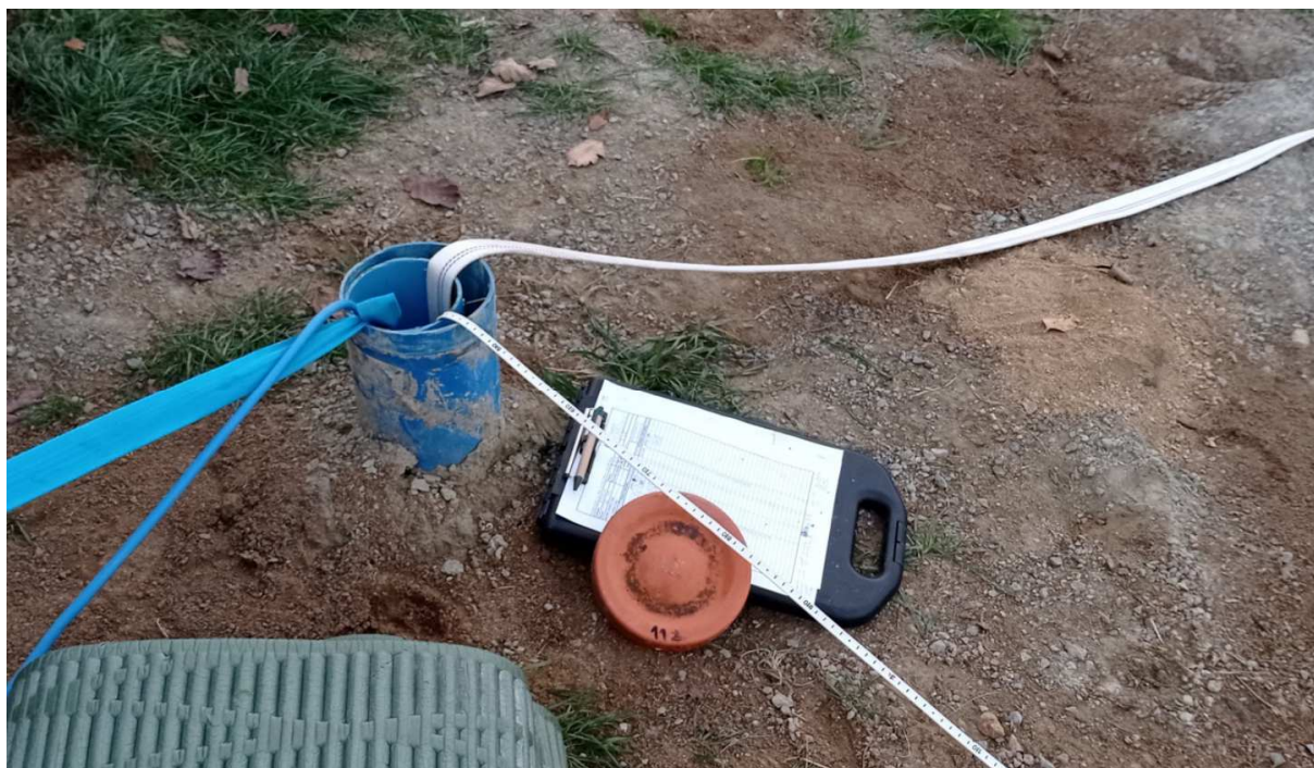
Foto 2: Realizace čerpací zkoušky ve vrtu HV 117
